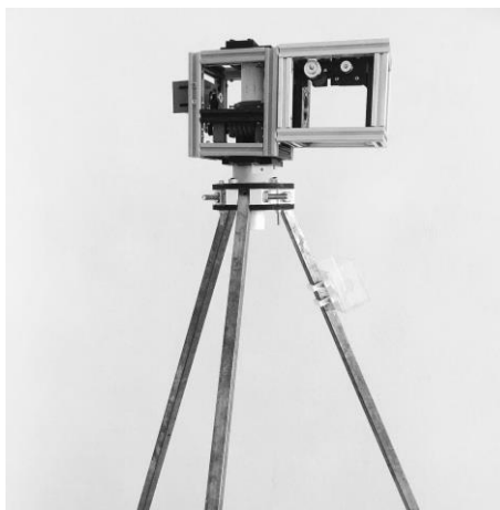
Рисунок 2 – Поворотное устройство для антенны УКВ диапазона (разработка ЦМИТ «Перспектива»).
