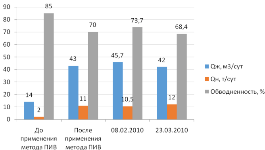
Рисунок 2 – Результаты применения плазменно-импульсной технологии на Дюсушевском месторождении
